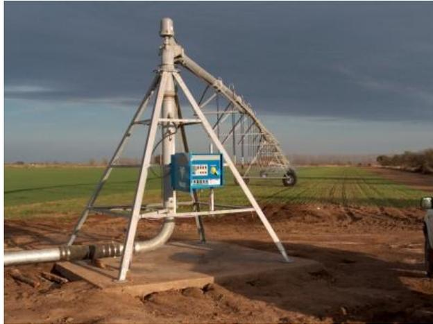
Figura 3.22 Sistema mecanizado de pivote central
