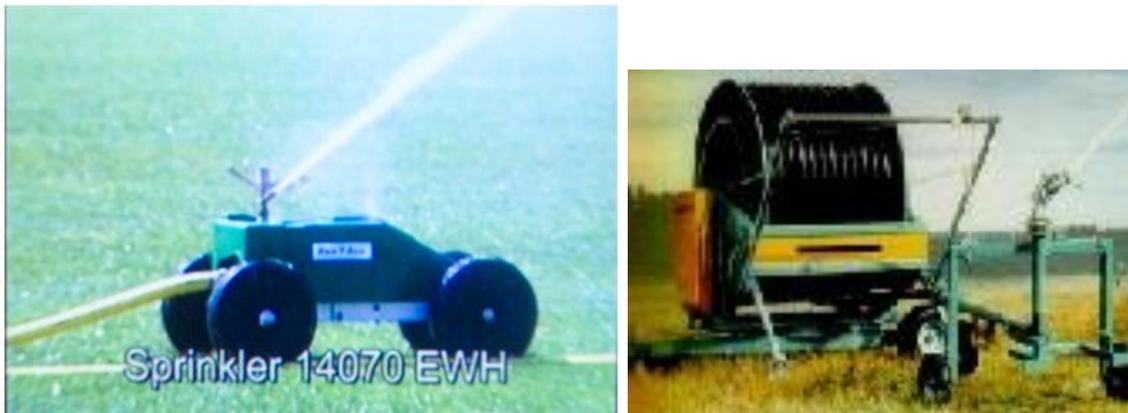
Figura 3.23 Sistema mecanizado con aspersores viajeros y cañón viajero
