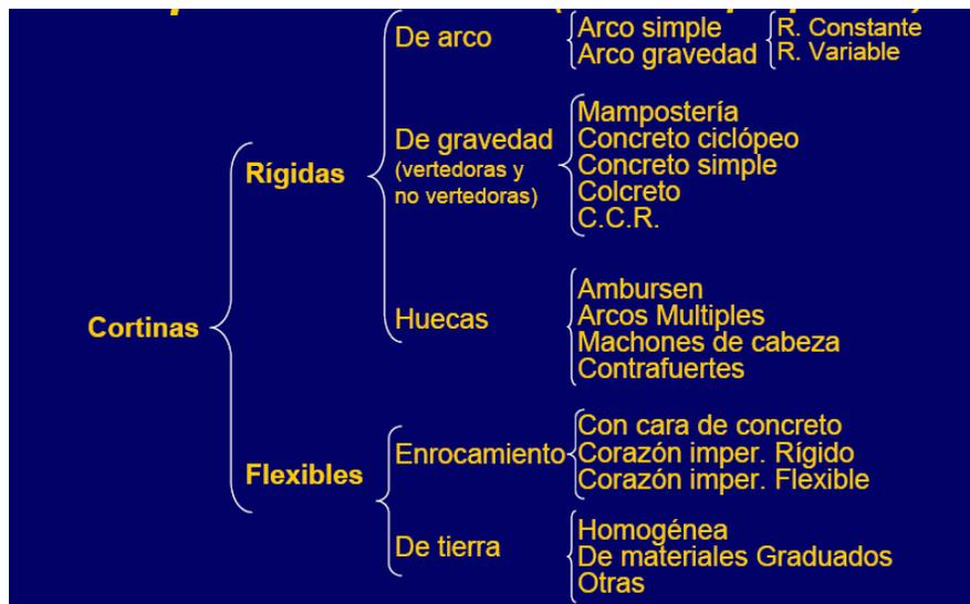
Figura 4.6 Clasificación de tipos de cortinas
