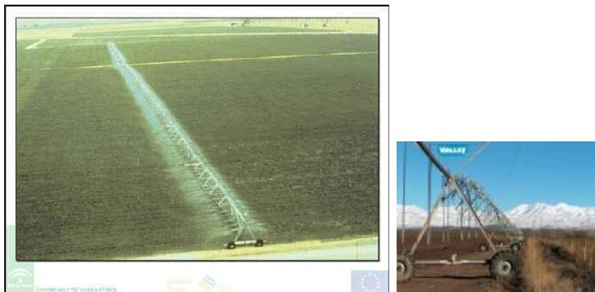
Figura 3.21 Sistema mecanizado de lateral con ruedas
