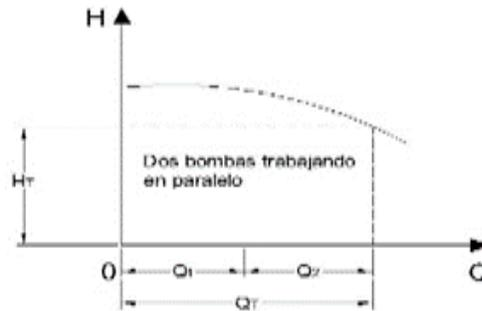
Figura 4.3 Operación de bombas en Paralelo.
