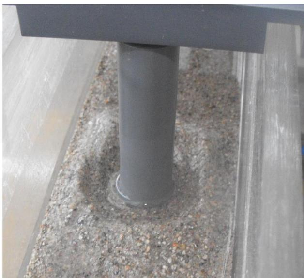
**Figura 2.2.** Socavación local en pilas.
